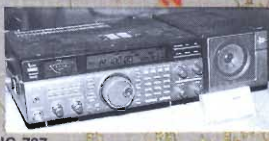
IC 737 Ricetrasmittitore HF multibanda con accordatore autonomo d'antenna - 500 KHz/30 MHz - 10/100 W SSB - CW, FM, 440 W AM 100 memoria
