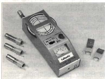
figura 8 - Il Grid Dip della Lafayette.
